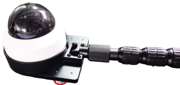
Cabezal domo P&T conectado a la pértiga de inspección.
